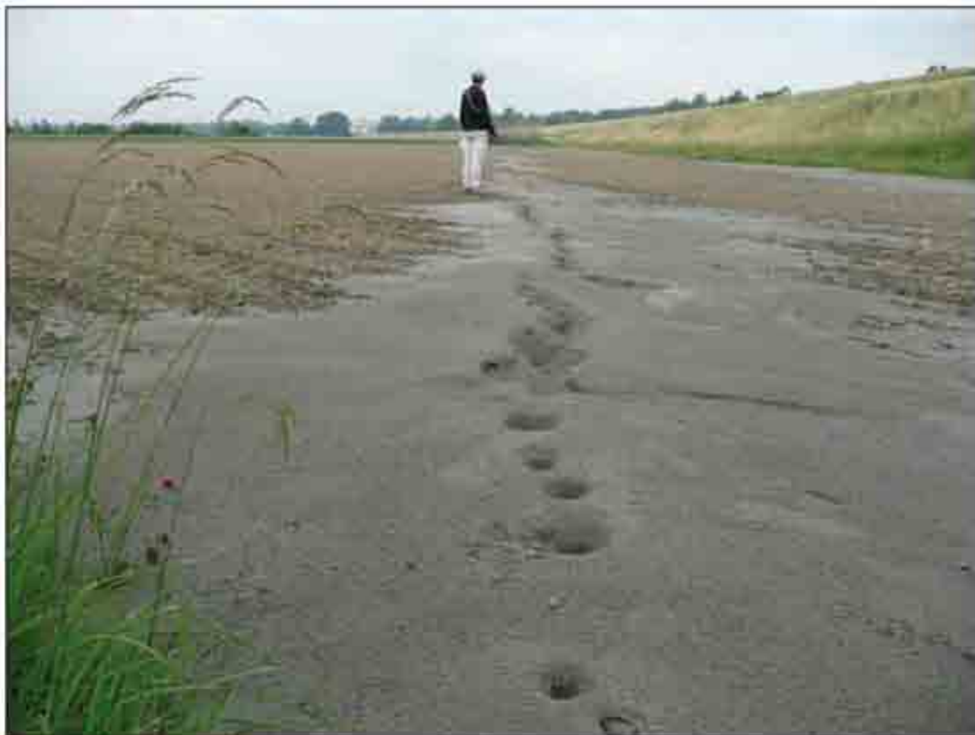
Comune di Pieve di Cento (BO) presso SP 13, in adiacenza dell'argine del Fiume Reno: terreni interessati dal fenomeno della liquefazione delle sabbie a seguito del terremoto del 20 maggio 2012. (Foto Daniele Magagnoli)
