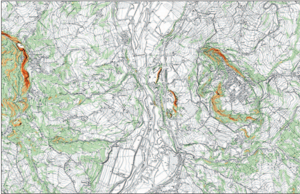
Figura 9 - Esempio di carta delle pendenze derivata da DTM 5 m X 5 m; aree non colorate: acclività \leq 15^\circ ; aree verdi: acclività compresa tra 15^\circ e 30^\circ ; aree arancioni: acclività compresa tra 30^\circ e 45^\circ ; aree rosse: acclività \geq 45^\circ
