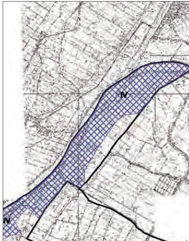
Figura 12 – Estratto della figura 3b <<possibilità di liquefazione dei paleoalvei per il Comune di Pieve di Cento>> (da: Relazione Geologica e Sismica del PSC). Il retino in blu indica per l’area di interesse “possibilità di liquefazione e di cedimenti significativi”
