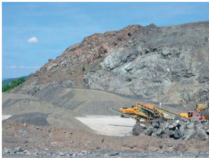
FOTO 2 – Gli impianti, fissi o mobili, di lavorazione degli inerti (frantoi) sono i principali utilizzatori delle risorse estrattive. (Comune di Terenzo, cava M.te Zirone). (Foto dell'autore).
