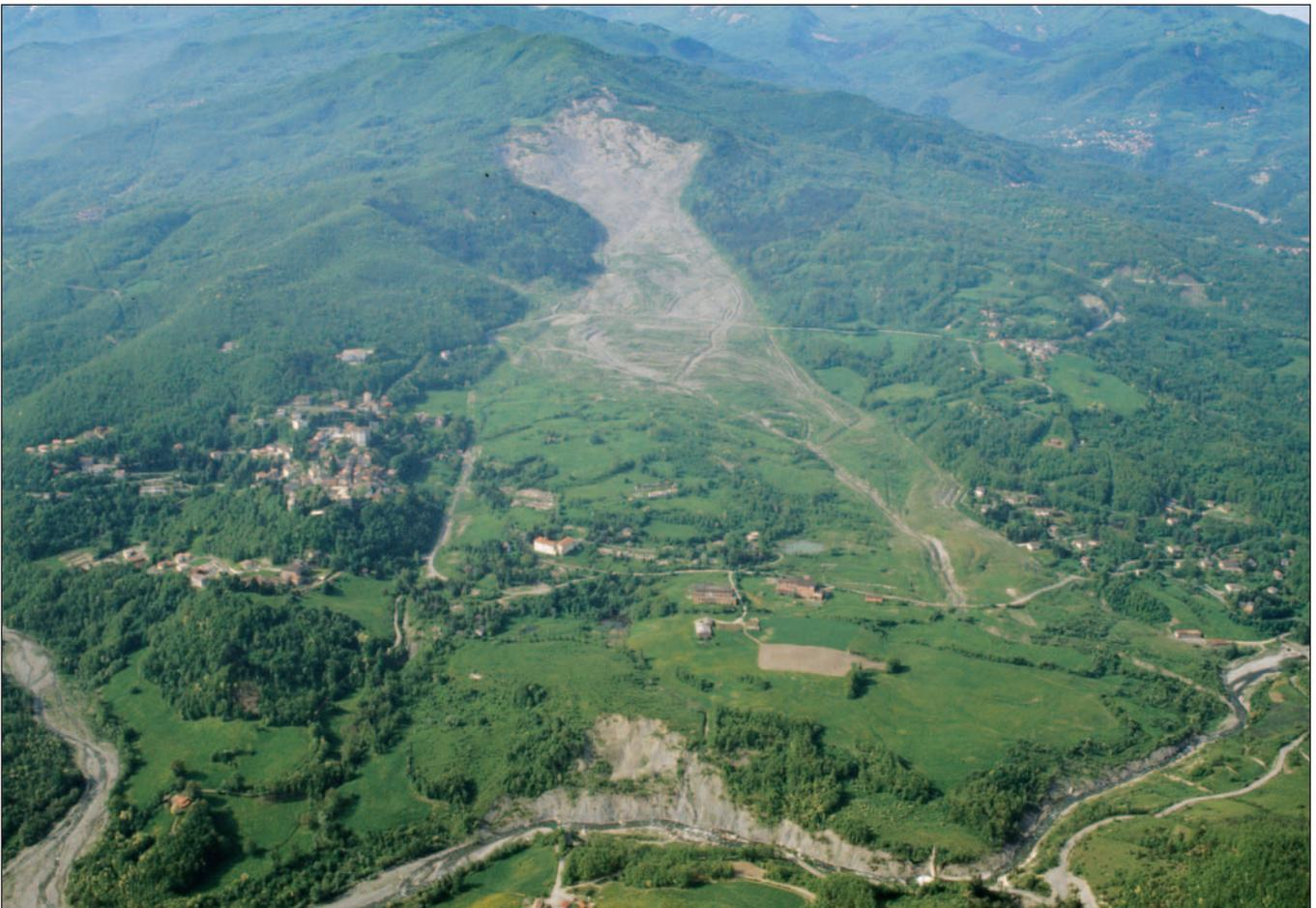
Figura 6 – In questa foto appare, in tutta la sua lunghezza (3 km), la grande frana di Corniglio, attiva dal 1994 al 2000 (Larini et al, 2001). In primo piano il piede della "Lama" sul T.Parma, con i resti della frazione "Linari", completamente distrutta. Il resto del capoluogo, sulla sinistra della foto, fu interessato da dissesti indotti dall'attrito del movimento della "Lama". Foto G.Bertolini, 2006.
