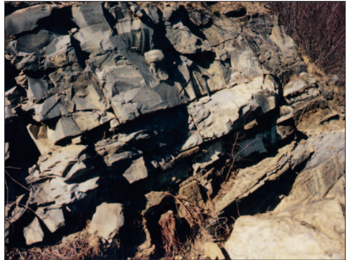
Fig. 5 - Particolare di una bancata metrica del flysch ad elmintoidi (OTO) che dovrebbe essere attraversato solo nella parte meridionale dello scavo nelle soluzioni 1, 2 e 3 (rossa, verde e blu).
